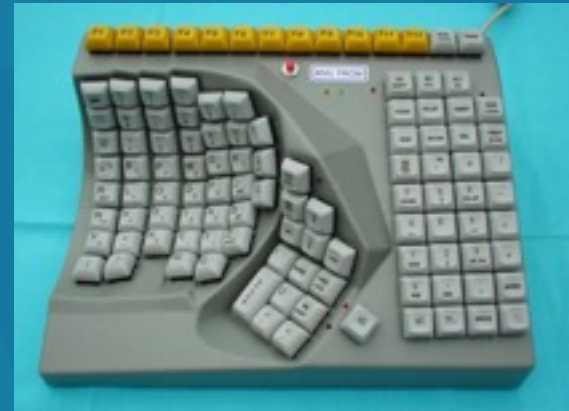
Clavier « une main » Maltron pour les gauchers (1990's)
